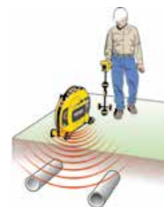
Induzieren eines Signals zur Lokalisierung von Versorgungsleitungen
