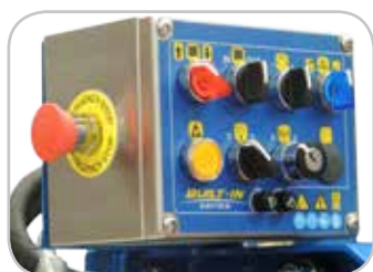
Quadro comandi bordo macchine (standard) con funzioni: - accensione/spengimento - on/off bypass - regolazione giri motore - avvolgi/svolgi tubo.
