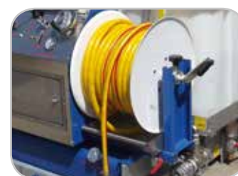
Naspo bassa pressione manuale: - 50 mt tubo 3/4"
