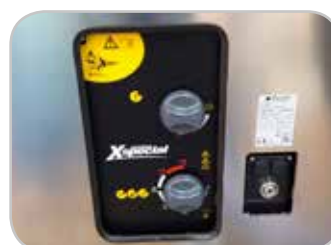
Quadro comandi con pannello motore e controllo acqua calda. Control panel with motor panel and hot-water control.
