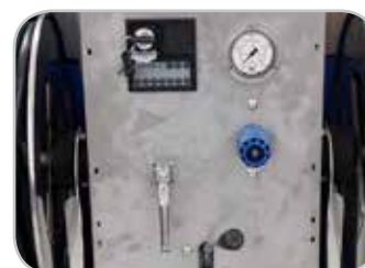
Versioni Basic con valvola on/off e regolatore di giri manuale.
