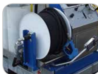
Naspo HP idraulico fisso + guida. Max tubo 100 mt 1/2" o 60 mt 3/4".
