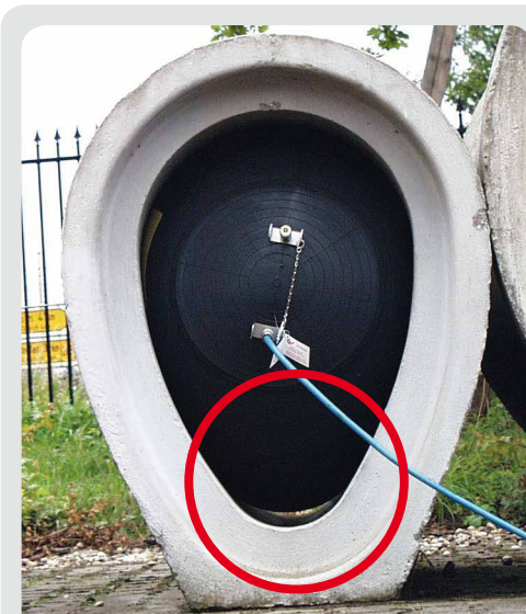
Eiprofil-Rohr mit Rundprofil-Dichtkissen – Anpassungsprobleme, keine Dichtigkeit.
