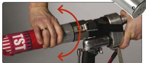
Schlauchschutz Durchmesser 47 mm (Drehgelenk)
