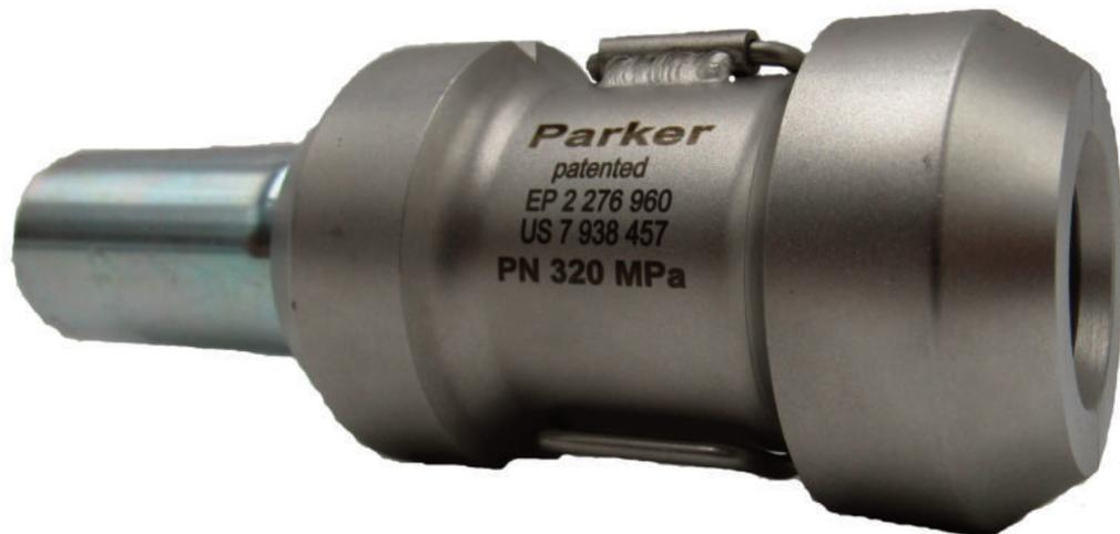
Die Polyflex LOK Adapter zeichnen sich durch ihre einfache, schnelle und komfortable Montage aus. Unbenommen der einfachen Montage, die auch ohne Werkzeug möglich ist, sind sie bis zu einem Betriebsdruck von 3200 bar mit einem Sicherheitsfaktor von 2,5 zugelassen. Durch einfaches Stecken sind somit praktisch keine Montagefehler mehr möglich und es wird verhindert, dass sich die Schläuche während der Anwendung verdrehen.
