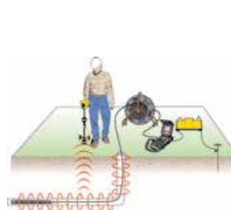
Kunststoffleitungen mit integrierter Leitungssuche aufspüren
