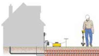
Direkter Anschluss an Versorgungsleitungen
